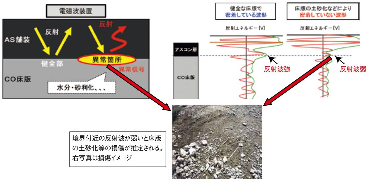
図-1 電磁波調査のイメージ
